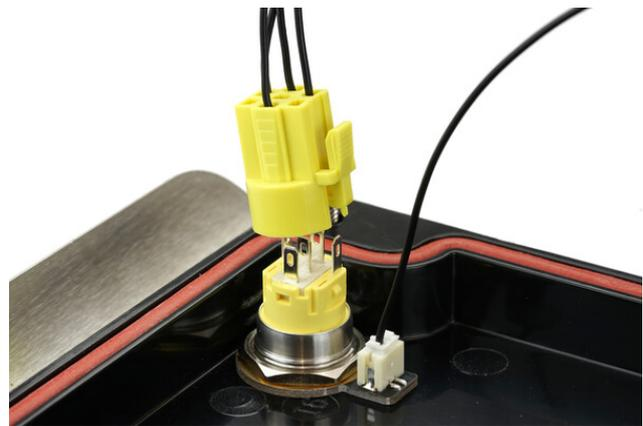
Zusätzlich muss der Erdungsstecker von der Frontblende abgesteckt werden. Erst danach kann der Deckel vollständig zur Seite gelegt werden.
