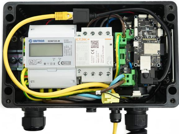
**Warp 2.0** Bei dem WARP Charger 2.0 befindet sich eine spritzwassergeschützte RJ45-Durchführung auf der Unterseite, an die der in der Wallbox verbaute Controller intern angeschlossen ist. Um ein LAN-Kabel anzuschließen, muss der Blinddeckel abgeschraubt werden.
