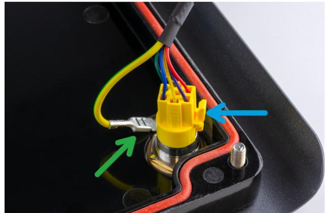
Zusätzlich muss der Erdungsstecker (grün) von der Frontblende abgesteckt werden. Erst danach kann der Deckel vollständig zur Seite gelegt werden.
