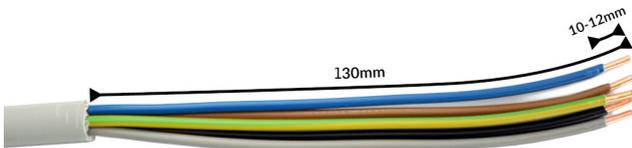
Die Zuleitung sollte für alle Varianten wie auf dem Foto oben abgebildet angefertigt werden. Wir empfehlen, das Kabel dafür auf einer Länge von mindestens 13 cm abzumanteln. Für die Klemmen wird eine Abisolierlänge von 10 bis 12 mm vorgegeben.
