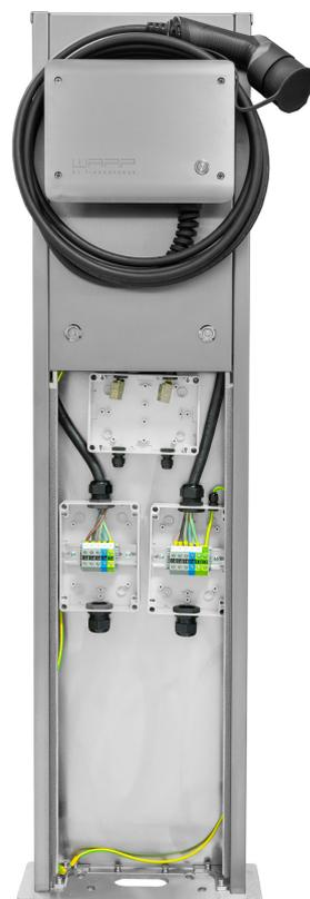
Im Verteilergehäuse befinden sich Klemmen vom Typ SRK 10 oder vergleichbar. Es können ein- und mehrdrähtige Leiter mit einem Querschnitt von bis zu 16 mm<sup>2</sup> und Leiter mit Aderendhülse mit einem Querschnitt von bis zu 10 mm<sup>2</sup> angeschlossen werden. Die Abisolierlänge beträgt 10 mm. Der Anschluss erfolgt anhand der Beschriftung der Klemmen im Verteilergehäuse.
